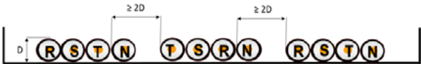
3 conductores por fase.
