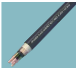
Cable AFUMEX CLASS VARINET RZ1C40Z1-K VFD 1 kV (AS) Cable para alimentación de motores con variadores de frecuencia. Conductores flexibles (clase 5).
