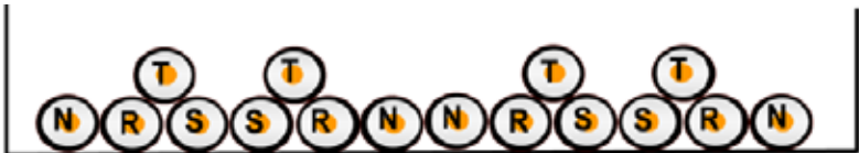
4 conductores por fase.
